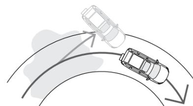
**RÉGULATEUR DE TRACTION** Si une roue perd son adhérence, le système TRAC limite la puissance du moteur et/ou agit sur le frein de la roue qui patine, et transfère le couple à la roue qui a encore de l'adhérence.
