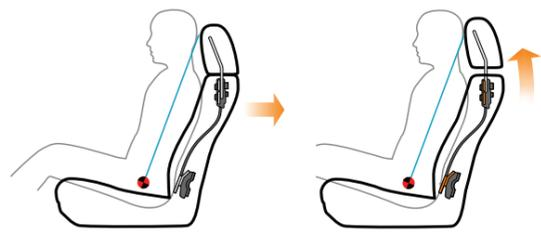
**APPUIS-TÊTE AVANT ACTIFS** Lors de certaines collisions arrière, un mécanisme intégré dans la région lombaire des sièges avant déclenche le mouvement des appuis-tête vers le haut et vers l'avant pour que ceux-ci puissent mieux soutenir la tête des occupants.
