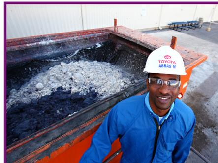
L'utilisation d'un filtre à gravité pour déshydrater les boues de peinture réduit la quantité de déchets qui doivent être traités à l'extérieur et permet de recycler les boues restantes.
