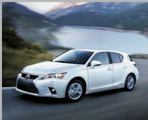
**CONTRÔLE DE LA STABILITÉ DU VÉHICULE (VSC)** Ce système surveille sans relâche votre contact avec la route. Il détecte instantanément tout dérapage des roues et aide à le contrôler en modulant la puissance du moteur et en appliquant de manière sélective les freins d'une ou de plusieurs roues. Ce dispositif travaille de concert avec les excellents systèmes de régulateur de traction (TRAC) et de freins antiblocage (ABS).
