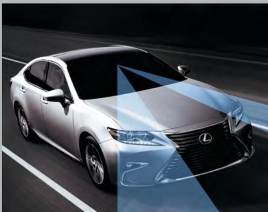
**ALERTE DE SORTIE DE VOIE** L'alerte de sortie de voie<sup>25</sup> est un système intelligent qui surveille la route devant vous et qui émet un signal sonore ainsi qu'une vibration du volant lorsque votre véhicule commence à sortir de sa voie sans que vous ayez actionné les clignotants.
