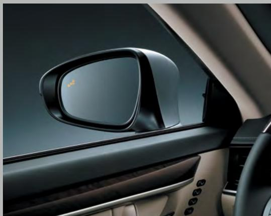
**MONITEUR D'ANGLES MORTS** La ES 2017 est munie du moniteur d'angles morts<sup>6</sup>, qui utilise des capteurs radar pour signaler la présence de véhicules qui ne sont pas visibles dans les rétroviseurs, vous permettant ainsi de vous concentrer sur la route.
