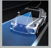
SYSTÈME D'ALERTE DE SORTIE DE **VOIE**<sup>12</sup> Alors que vos yeux fixent la route, un système de caméra fait de même et détecte les lignes tracées sur la route, et vous alerte lorsque le véhicule sort de sa voie.
