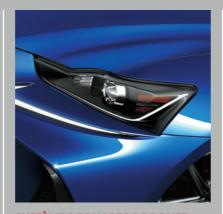
SYSTÈME DE PHARES DE ROUTE **AUTOMATIQUES**<sup>18</sup> Illuminez la route à votre quise. Grâce à des caméras embarquées, ce système évalue la luminosité de l'éclairage de rue, détecte les phares ou les feux des véhicules qui viennent en sens inverse ou qui vous précèdent, et bascule automatiquement entre phares de route et phares de croisement, selon la situation.
