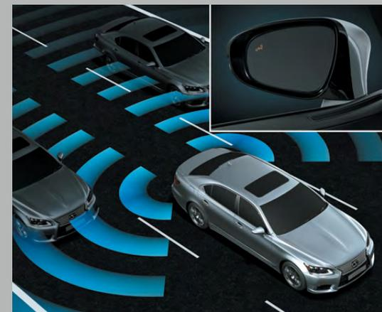
**MONITEUR D'ANGLES MORTS<sup>16</sup>** La LS 2017 est munie du moniteur d'angles morts<sup>16</sup>, qui utilise des capteurs radar pour signaler la présence de véhicules qui ne sont pas visibles dans les rétroviseurs, vous permettant ainsi de vous concentrer sur la route.
