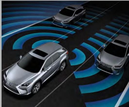
**DES CAPTEURS DE PRÉCISION** Le NX 2017 est muni de radars montés à l'arrière qui détectent les véhicules que vous ne pouvez pas voir, tandis qu'une icône clignote dans votre rétroviseur extérieur pour vous aviser<sup>8</sup>. Et lorsque vous faites marche arrière, le système d'alerte de circulation transversale arrière<sup>4</sup> détecte les véhicules à proximité.
