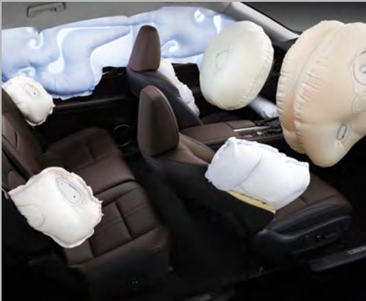
**8 COUSSINS GONFLABLES DE SÉRIE** La multitude de caractéristiques de sécurité du NX inclut des coussins gonflables latéraux montés dans les sièges avant, un coussin gonflable de protection des genoux du conducteur, un coussin gonflable monté dans le coussin du siège du passager avant, des coussins gonflables latéraux en rideau à détecteurs de roulis (RSCA) et des coussins gonflables latéraux à l'arrière<sup>18</sup>.
