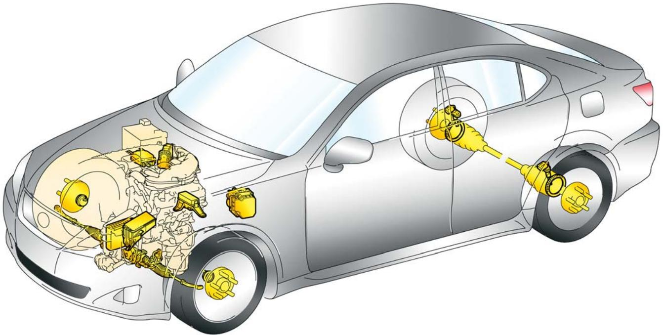
Ce système coupera le moteur en cas d'enfoncement simultané de la pédale de frein et de la pédale d'accélérateur. Ce système intervient à des vitesses de 10 km/h et plus ou si l'ouverture du papillon des gaz est à une valeur qui sollicite le moteur à produire plus de puissance.
