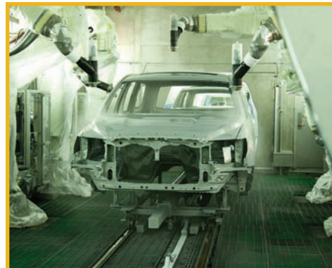
La conversion des cabines de peinture à notre usine de Princeton (Indiana) pour des systèmes hydrosolubles devrait réduire de 27 % les émissions de COV.
