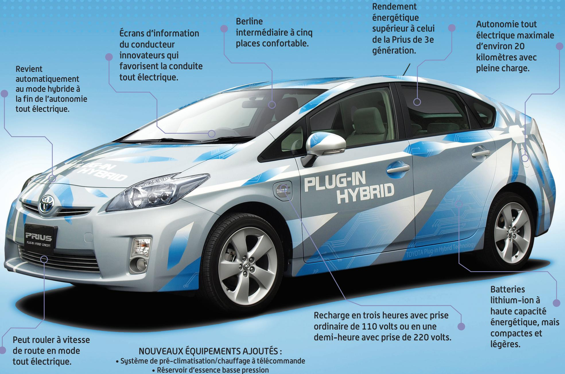
Revient automatiquement au mode hybride à la fin de l'autonomie tout électrique.
